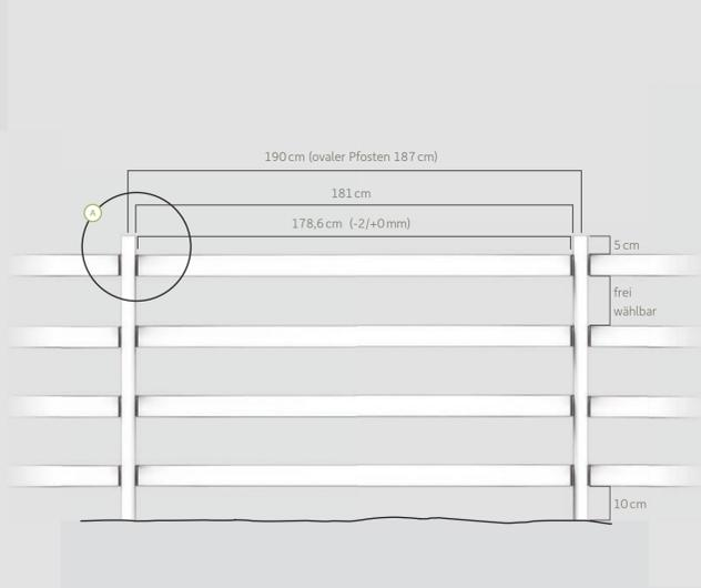
1. Rahmenmontage siehe „Rahmenkonstruktion“ Abb. 1 bis 6.
