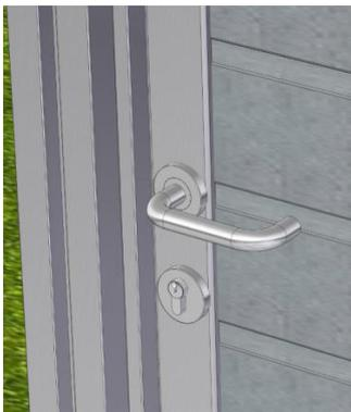
Stecken Sie die Drückergarnitur inkl. Kunststoffrosetten beidseitig in die dafür vorgesehenen Öffnungen, dazwischenliegend den Vierkantstift, und verschrauben Sie mit jeweils 3 Senkkopfschrauben 3,5 x 16 mm (pro Seite) durch die vorhandenen Bohrungen (Bohrungen in den Kunststoffrosetten und im Aluminiumrahmen müssen übereinstimmen).
